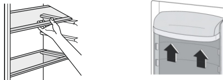
Рисунок 32 - Регулировка полок холодильника и дверных полок.
